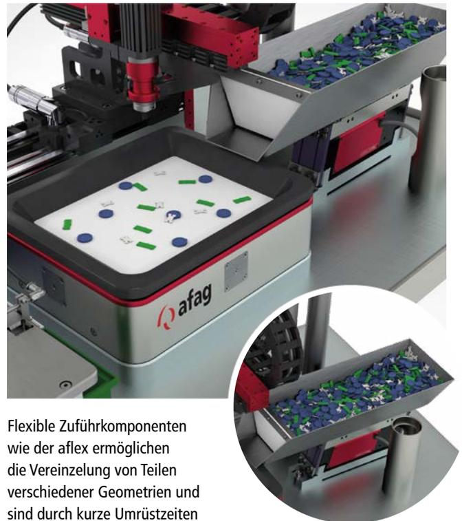
Flexible Zuführkomponenten wie der aflex ermöglichen die Vereinzelung von Teilen verschiedener Geometrien und sind durch kurze Umrüstzeiten für vielseitige Anwendungen geeignet.
