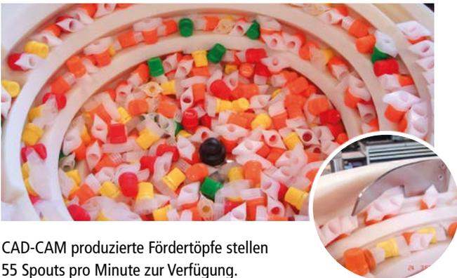
CAD-CAM produzierte Fördertöpfe stellen 55 Spouts pro Minute zur Verfügung.
